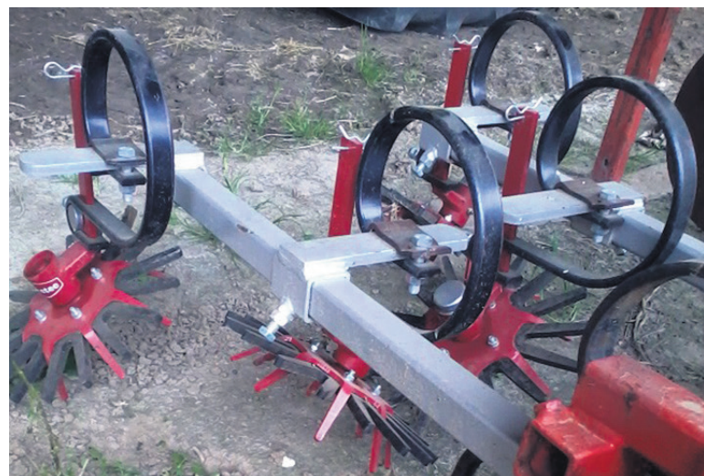
Les moulinets de la bineuse permettent de désherber au plus près du rang de betterave.
