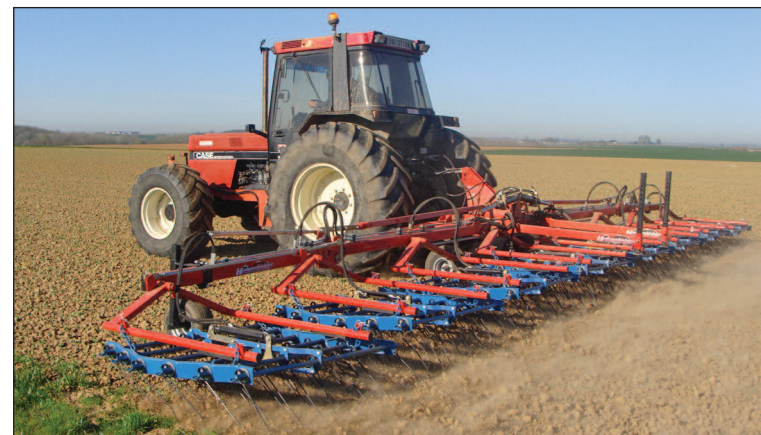
Désherbage à la herse étrille sur pois de printemps.
